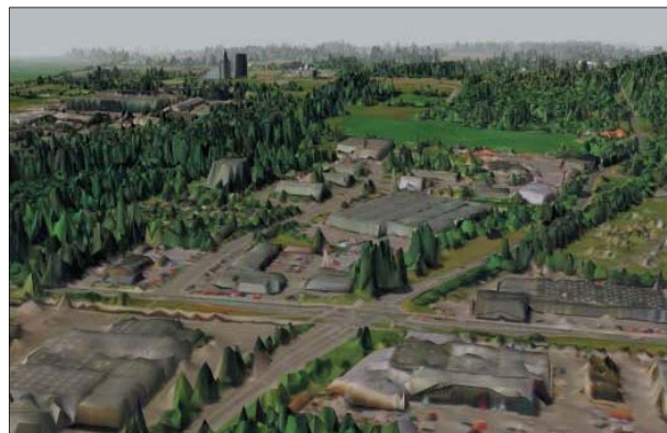
Figur 24 – DSM med ortofoto - er uegnet til realistiske visualiseringer.
